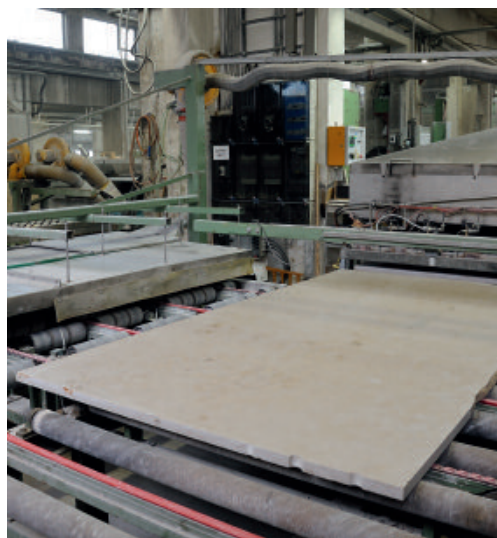
Zerteilung der Blöcke mit der Gattersäge und Weiterverarbeitung der Rohplatten
